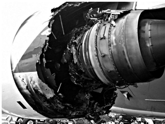
Na snímku pořízeném po přistání na letišti Singapur je vidět rozsáhlé poškození motoru č. 2 letadla Airbus A 380 společnosti Qantas.
