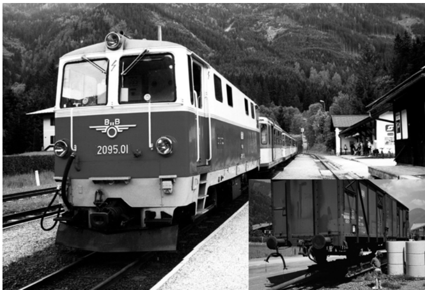
Úzkorozchodná lokomotiva 2095.01 se soupravou vozů čeká na odjezd ze žst. Krimmel do žst. Zell am See. V pravém dolním rohu je ukázka přepravy normálně rozchodných nákladních vozů na speciálních podvozcích o rozchodu 760 mm. Foto © autor, červen 2000.
